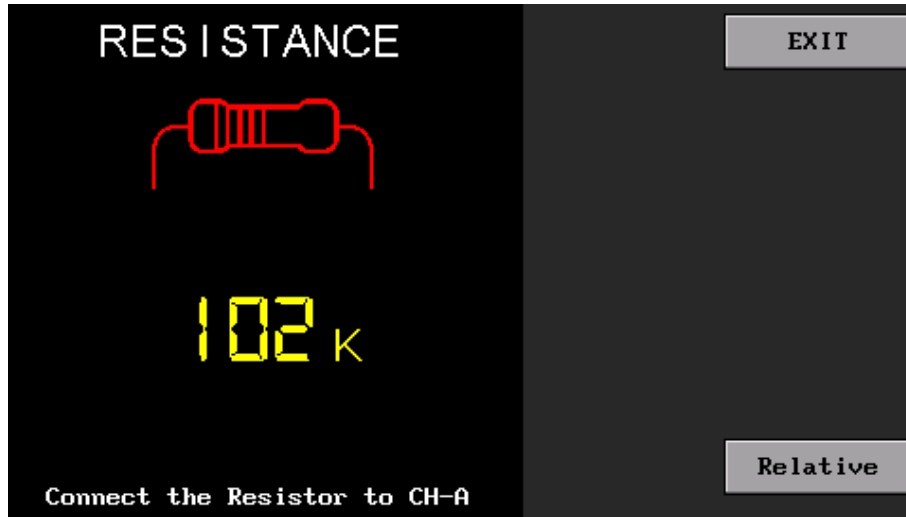
Şekil 20. Kısa devre bulucu modunda 100K direnç ölçümü
